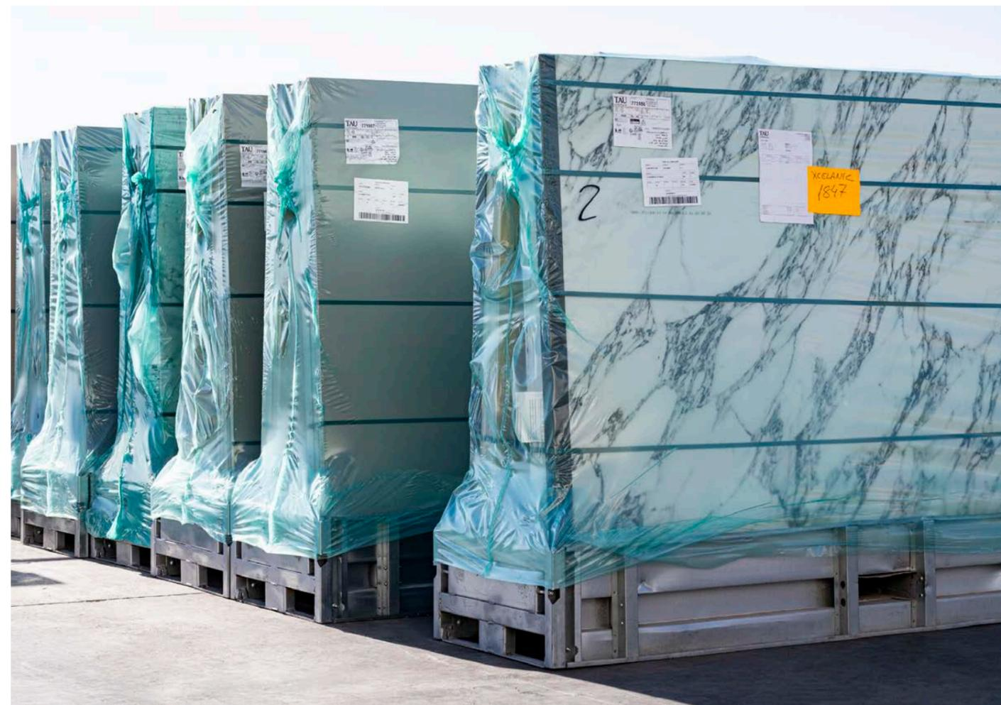
As placas da Ascale devem ser carregadas, descarregadas e transportadas nos cavaletes com o auxílio de uma empilhadora, grua ou outro dispositivo de manipulação.
