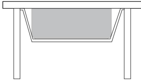
En función del proyecto (como en el caso de ranuras repetidas y cercanas), valore la posible necesidad de reforzar el perímetro del recorte aplicando un perfil Ascale con un adhesivo adecuado bajo la encimera.
