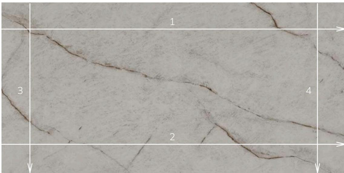
Debido a la dureza del material Ascale, se debe procurar una buena refrigeración del disco. El chorro del agua refrigerante tiene que ser continuo y apuntar en todo momento al punto del corte, donde el disco está en contacto con la tabla:
