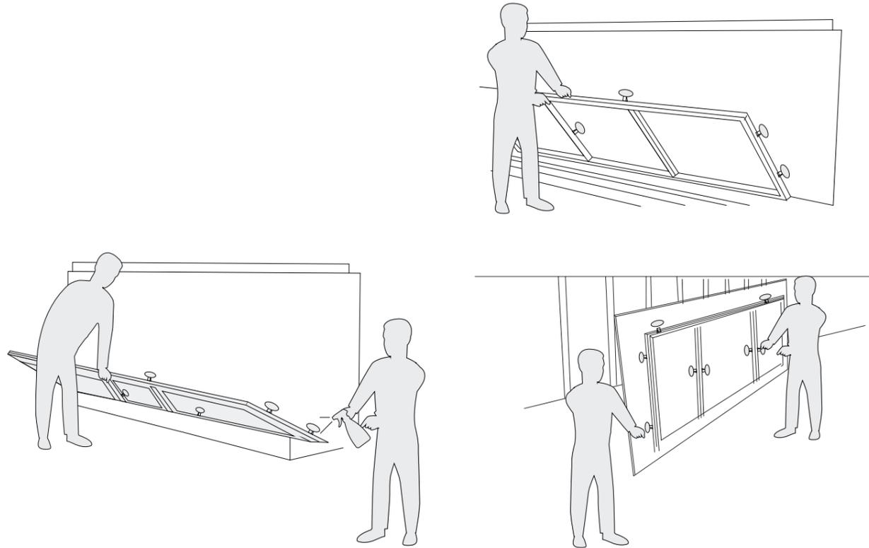
En el caso de no disponer de este tipo de marco, se puede utilizar una barra de aluminio o similar, fijado con varios gatos. Así se evitará que la pieza flexione demasiado durante su manejo.
