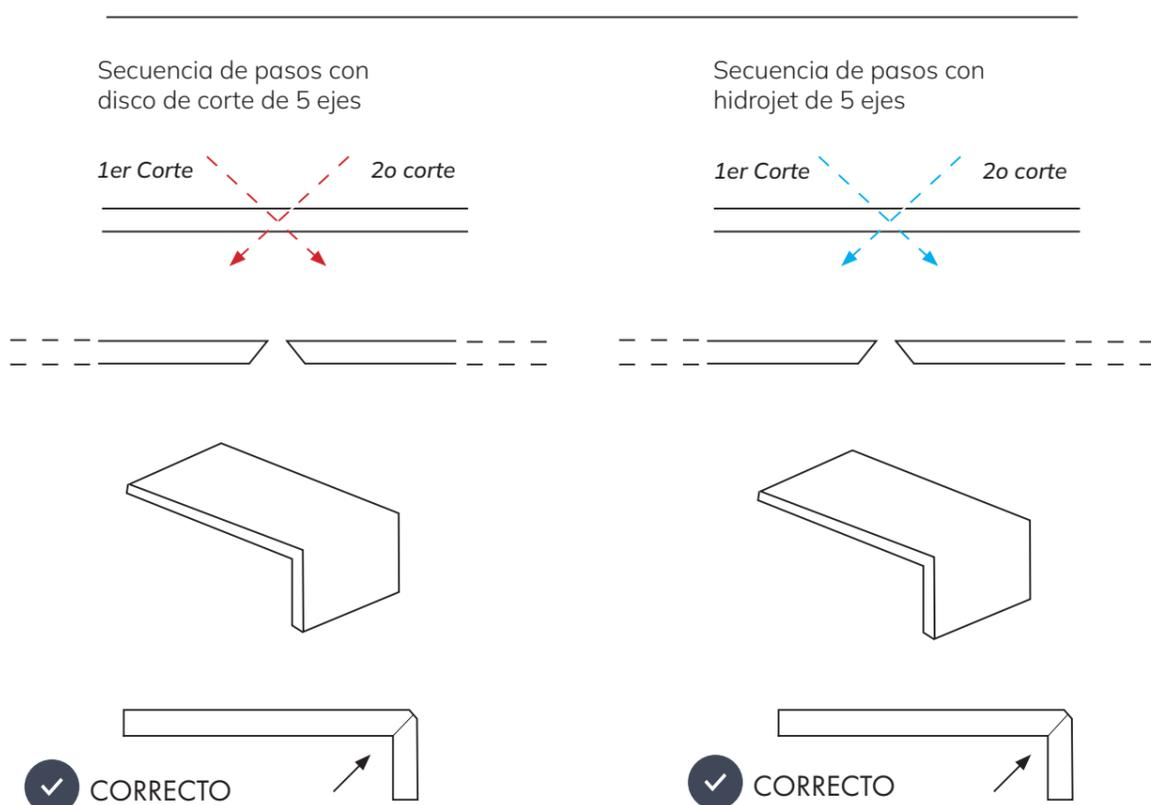
Sugerimos reforzar la junta aplicando perfiles hechos con partes no utilizadas de las placas Ascale, fijados con el mismo tipo de adhesivo utilizado para pegar el ángulo a 45°.
