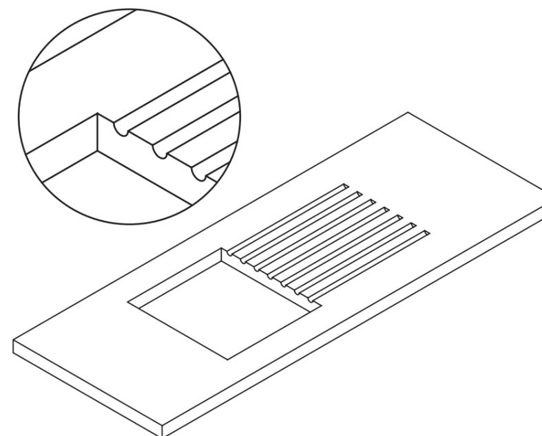
Se debe tener en cuenta que al hacer las hendiduras se mostrará el color base de la tabla, que puede contrastar con el diseño de la superficie en algunos modelos. Según el modelo, las hendiduras pueden cambiar de color y quedar sin diseño.
