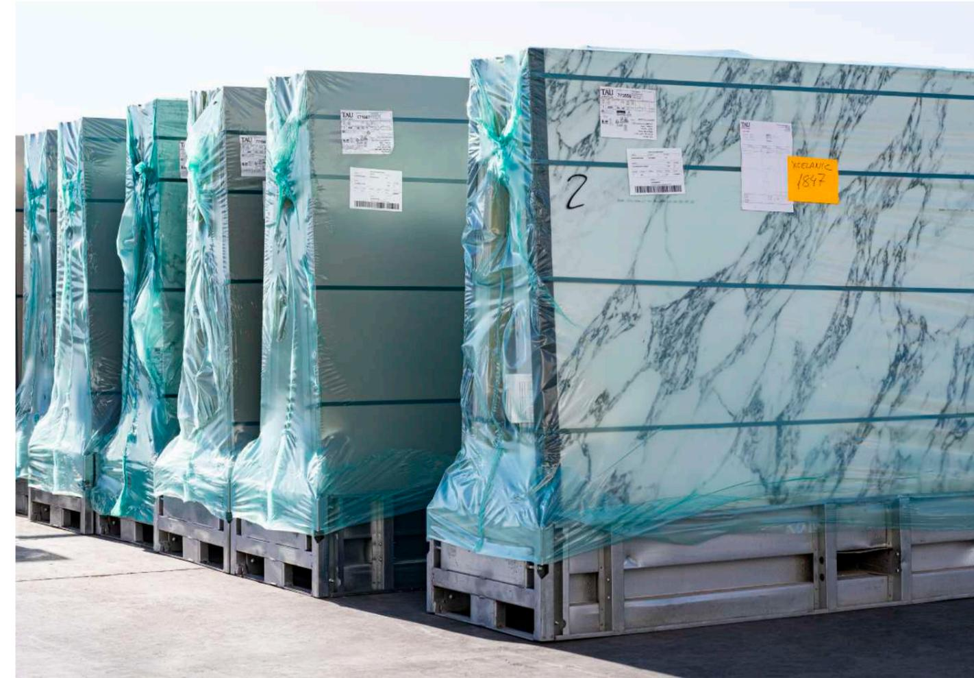
Los caballetes de tablas de Ascale se deben cargar, descargar y transportar utilizando una carretilla elevadora adecuada, una grúa u otro dispositivo de manipulación.
