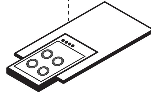
El procesamiento de las placas Ascale 12+ y 20+ para obtener los agujeros de colocación de los fregaderos o electrodomésticos debe hacerse solo después de una cuidadosa evaluación de las medidas de procesamiento indicadas en la ficha técnica del producto a instalar, en función del método de instalación.
