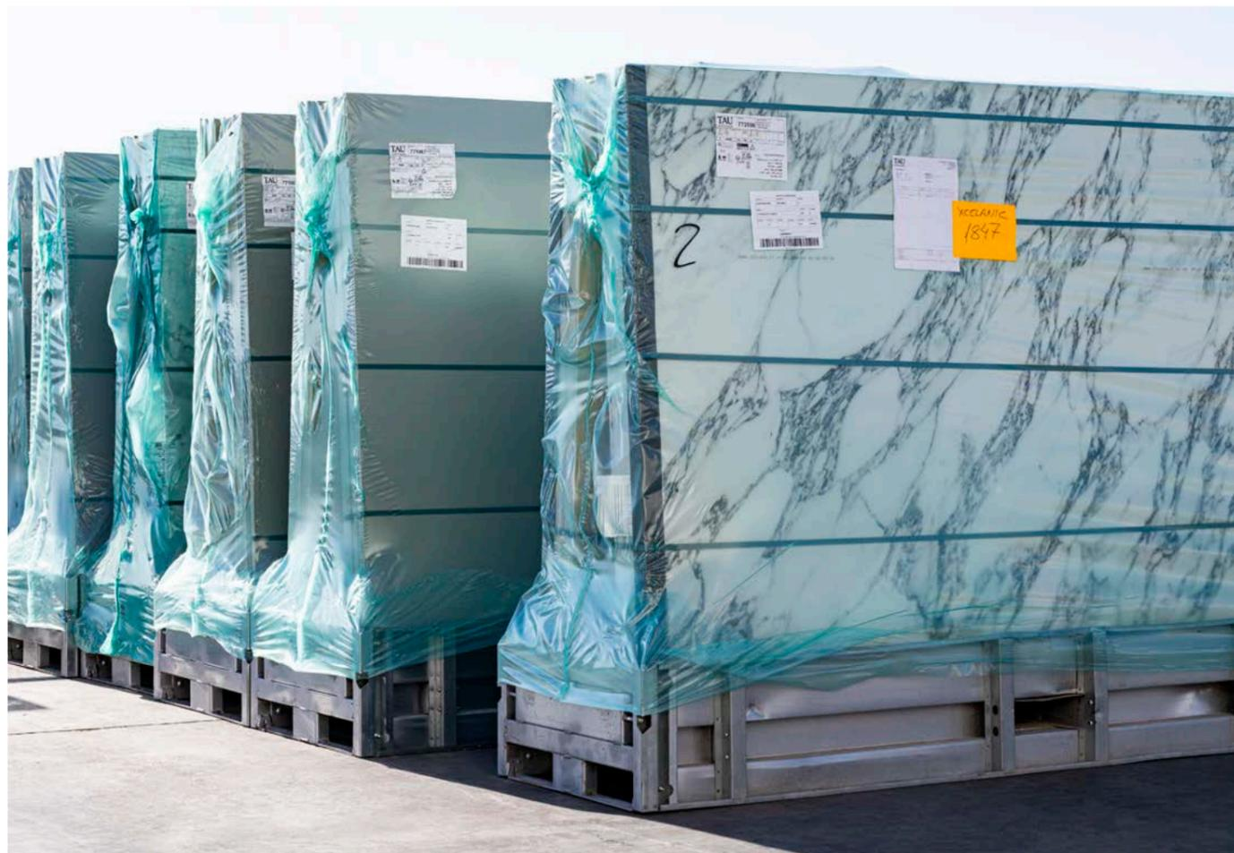
Los caballetes de tablas de Ascale se deben cargar, descargar y transportar utilizando una carretilla elevadora adecuada, una grúa u otro dispositivo de manipulación. En todos los casos de manipulación y transporte se debe prestar atención a que la carga esté equilibrada.
